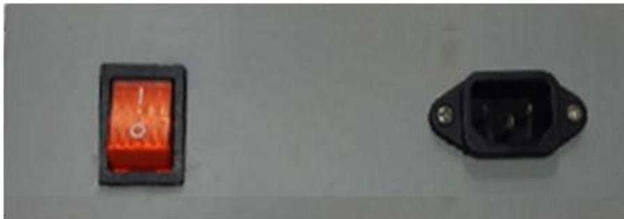
Gambar 4. Pemasangan Power Switch dan Inlet Soket Pada Panel Belakang
