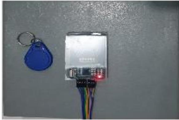
Gambar 7. RFID Reader di Atas Tutup Kotak panel
