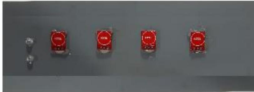
Gambar 3. Pemasangan Indikator LED dan Sensor Sentuh Pada Panel Depan
