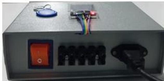
Gambar 8. Kotak Panel Belakang yang Dipasang Terminal Blok
