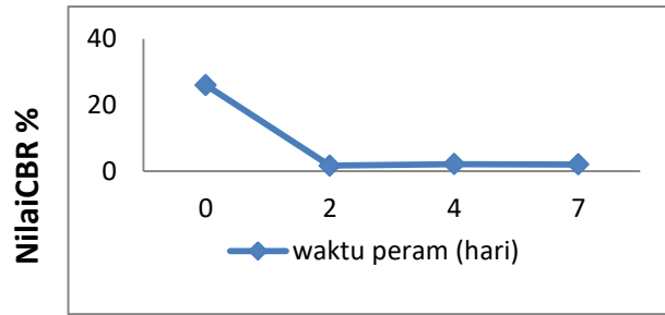
Gambar 2. Hubungan Nilai CBR dengan waktu perendaman (tanah asli)
