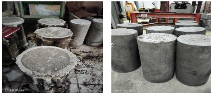
Gambar 3. Benda uji beton
