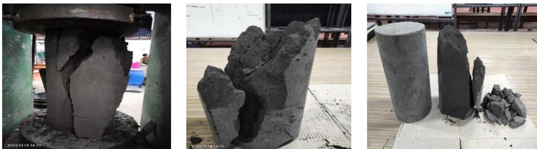
Gambar 2. Keruntuhan akibat uji tekan sampel agregat buatan
