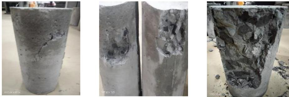
Gambar 4. Keruntuhan akibat uji kuat tekan beton dengan agregat buatan
