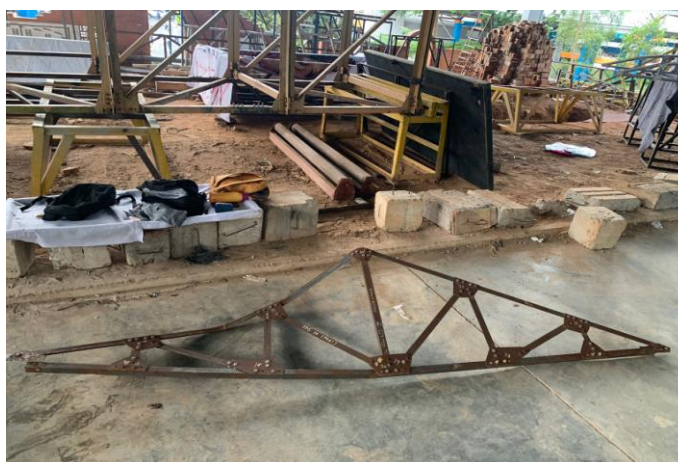
Gambar 2. Benda Uji Konstruksi Kuda-Kuda Baja
