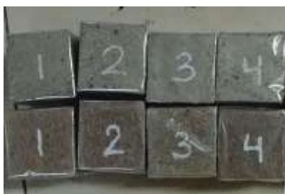
Gambar 4. Metode perawatan bungkus plastik di laboratorium
