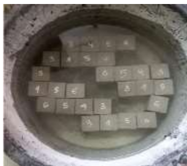
Gambar 2. Metode perawatan rendam air di laboratorium
