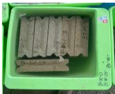
Gambar 6. Metode perawatan rendam air di pabrik
