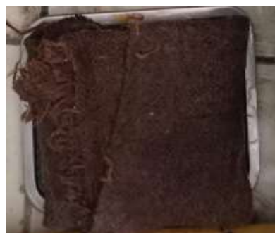
Gambar 3. Metode perawatan bungkus goni basah di laboratorium
