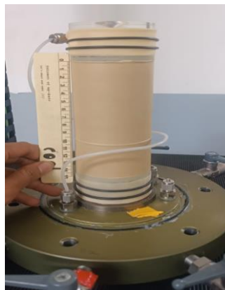
Gambar 3 Sampel tanah pasir Rembang setelah dicetak dan diberikan tekanan negatif
