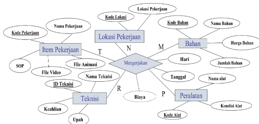
Gambar 2. ERD (Entity Relationship Diagram) Pemeliharaan Komponen Arsitektur Gedung
