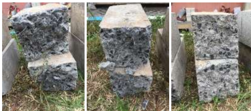
Gambar 6. Penampang Patah Balok dengan Serat Kaawat Tersebar
