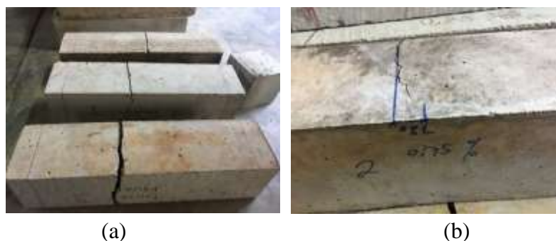
Gambar 4. Pola Balok Patah Yang Dihitung Dengan Persamaan (2) (a) dan (3) (b)
