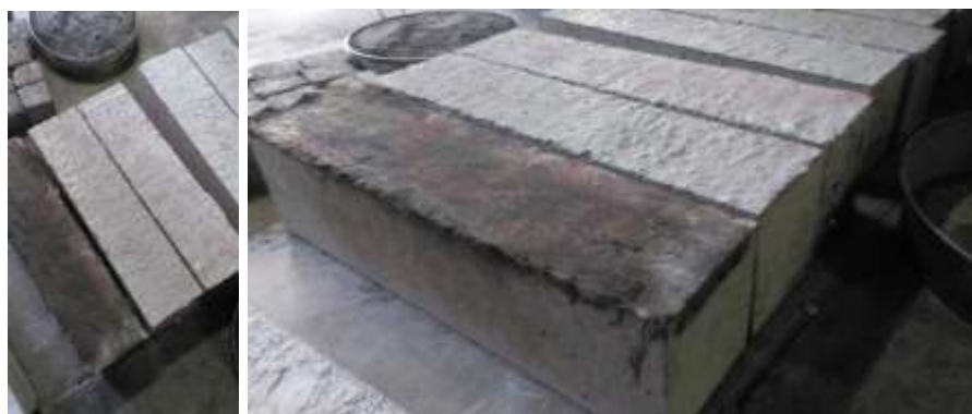
Gambar 7. Woven Roving Melekat dengan Baik pada Permukaan Beton
