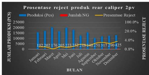
**Gambar 4. Prosentase Reject Produksi Rear Caliper 2pv Tahun 2016**
