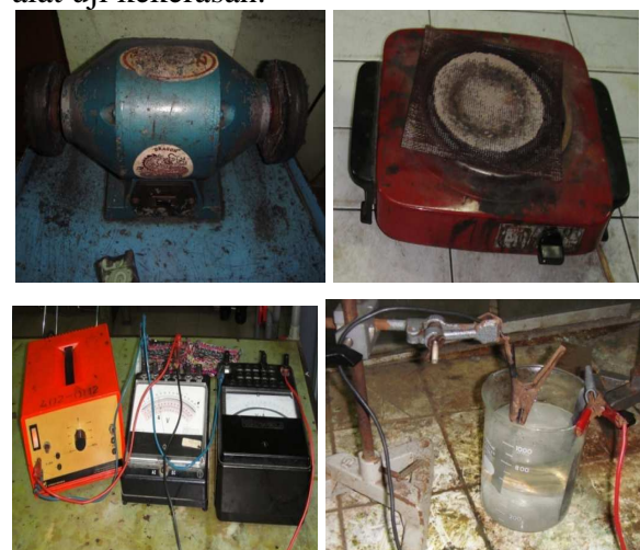
Gambar 3. Peralatan pelapisan nikel dan nikel + tembaga (Gerinda poles, Kompur listrik, Rectifier, Amper meter, Volt meter, Gelas)
