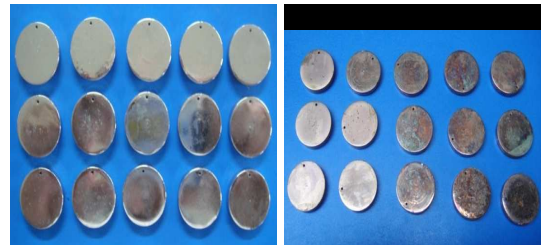
Gambar 6. Spesimen hasil pelapisan nikel dan nikel + tembaga
