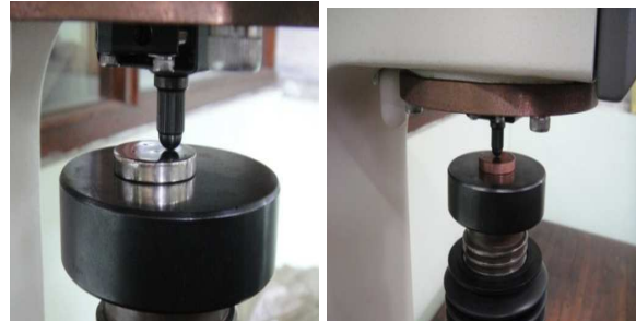
Gambar 7. Pengujian kekerasan spesimen hasil pelapisan nikel dan nikel + tembaga
