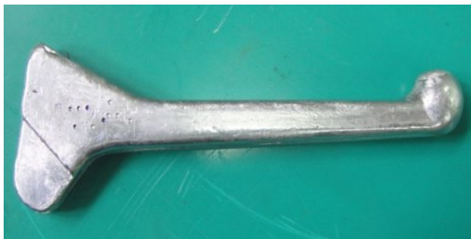
Gambar 11. Produk tuas rem sepeda motor (Spesifikasi : t x l x p : 10 mm x 38 mm x 135 mm, berat = 51 gram)
