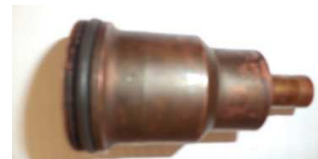
Gambar 13. Copper sleeve yang telah tercabut
