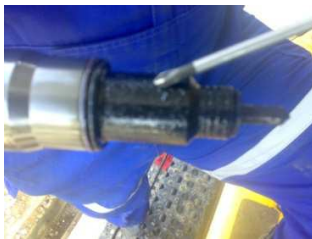
Gambar 8. Unit injector pada copper sleeve yang rusak
