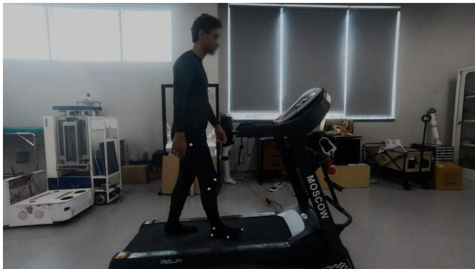
Gambar 2. Proses pengambilan data gerak berjalan pada treadmill
