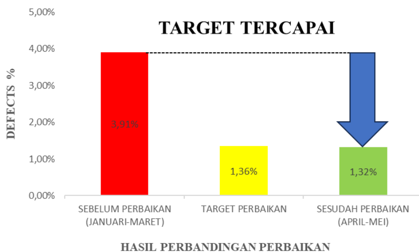
Gambar 7. Grafik Perbandingan Tingkat Cacat Permukaan Outer Tube Model 2DP Sebelum dan Sesudah Perbaikan
