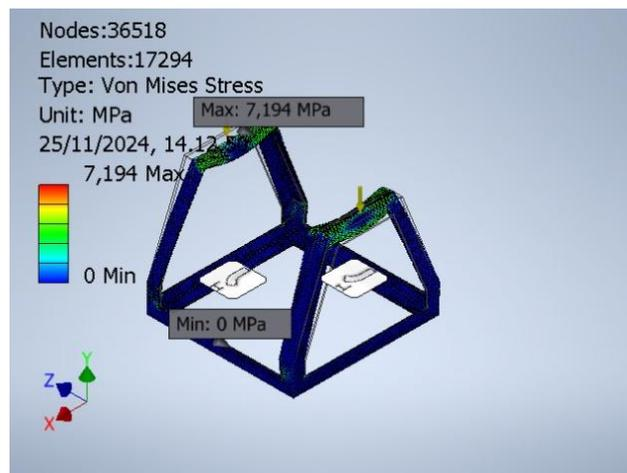
**Gambar 4.** Hasil simulasi distribusi tegangan Von Mises pada struktur rangka dengan pembebanan statik 637 N
