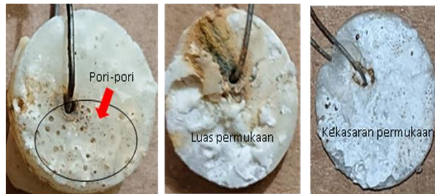
Gambar 5. Fenomena degradasi permukaan pada spesimen biokomposit
