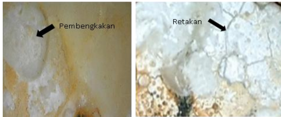
Gambar 7. Pembengkakan dan retakan disebabkan infiltrasi cairan SBF ke dalam material
