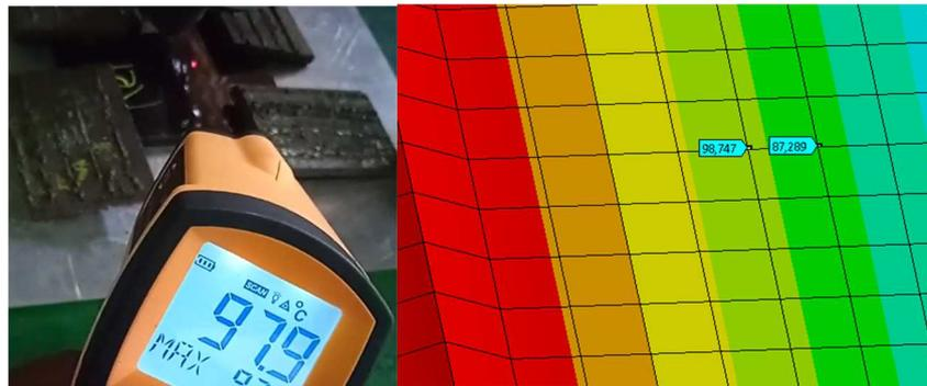
**Gambar 7.** Perbandingan pengujian material pada titik B dengan *extrusion temperature* 315°C menghasilkan selisih presentase 0,87% (max)
