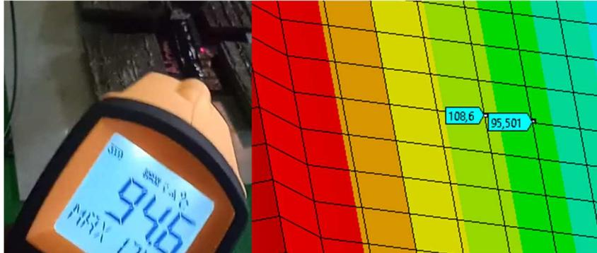
**Gambar 8.** Perbandingan pengujian material pada titik B dengan *extrusion temperature* 340°C menghasilkan selisih presentase 0,95% (min)
