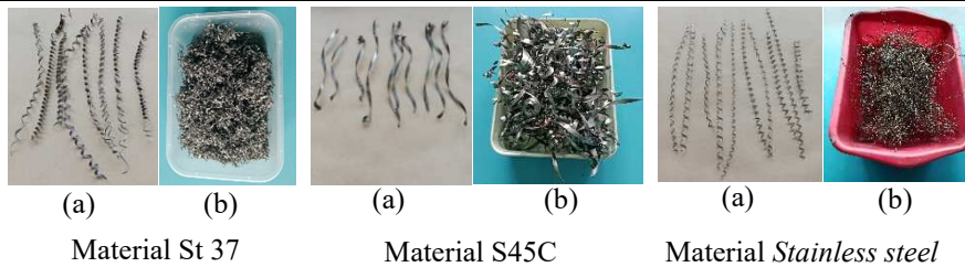
Gambar 5. Bentuk dan tempat geram sebelum dipres.
