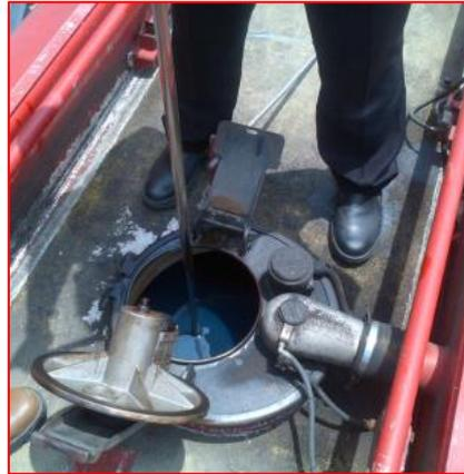
**Gambar 1.** Pengukuran menggunakan stik ukur
