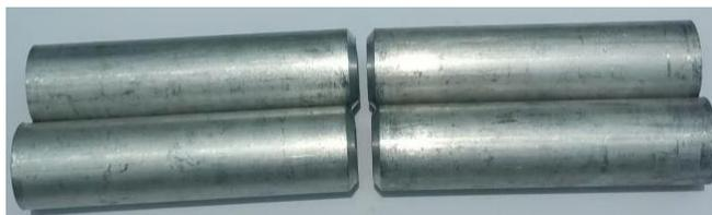
**Gambar 1.** Pipa aluminium 6063 dengan sudut kampu v 25°.
