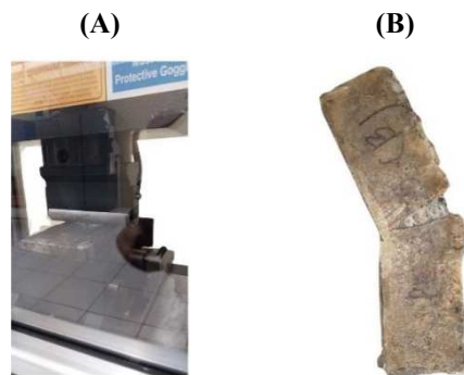
Gambar 7. (A) Spesimen sebelum diuji bending (B) Spesimen setelah diuji bending
