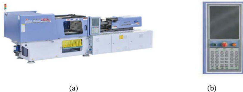
Gambar 4. Mesin plastik injeksi: (a) Hwa Chin 160 SE, (b) Panel kontrol pada layar
