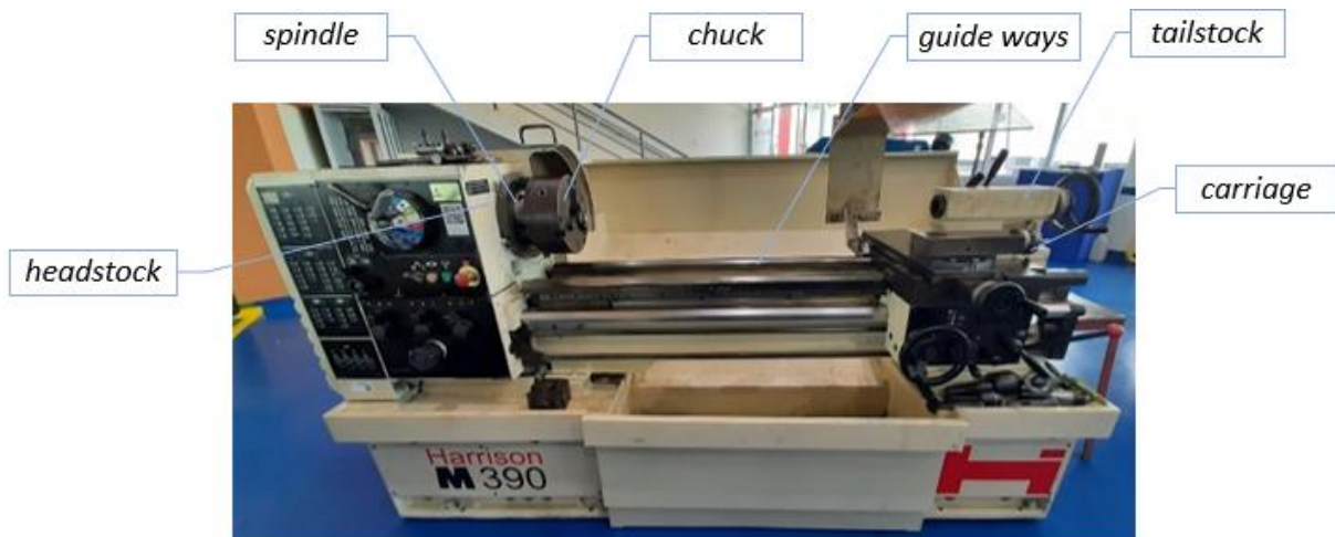
Gambar 2. Mesin Bubut Harrison M390 Beserta dengan Bagiannya
