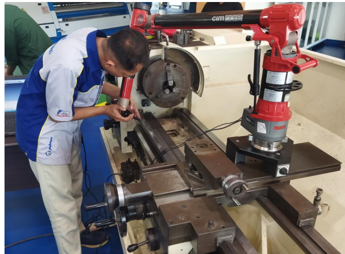
Gambar 4. Proses Pengambilan Data CMM
