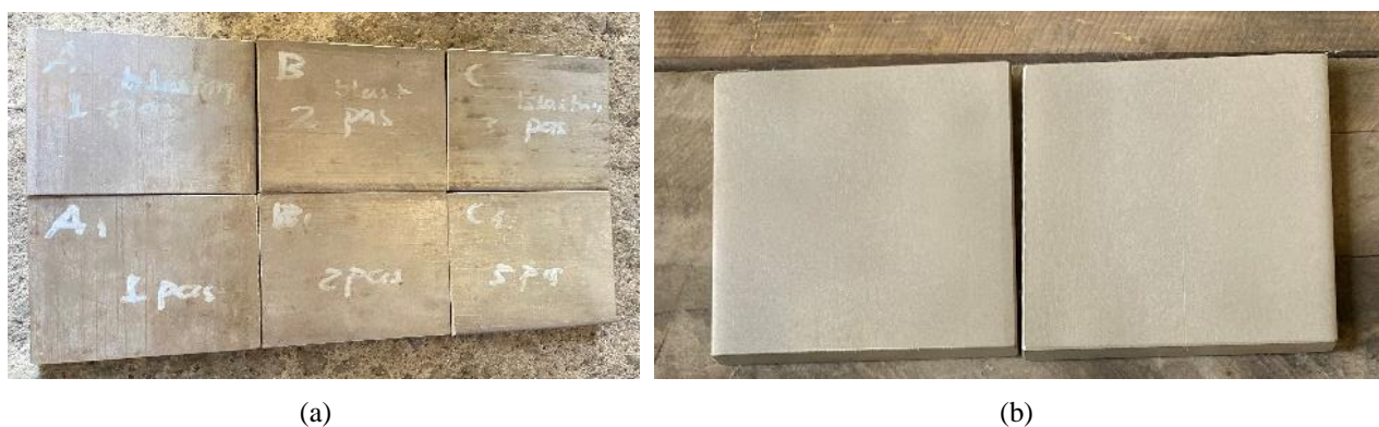
Gambar 1. Material Substrat Sebelum (a) dan Sesudah (b) Sandblasting
