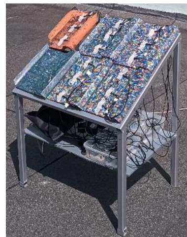
Gambar 2. Skema Pengujian Radiasi Matahari Pada Genteng Komposit
