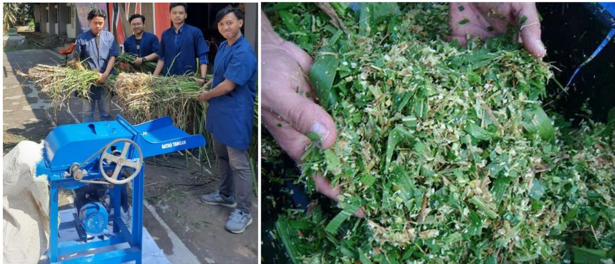
**Gambar 3.6.** (a) Proses pengujian dan (b) hasil cacahan rumput gajah
