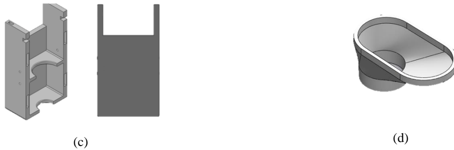
Gambar 4. Komponen printing : (a) Bracket motor, (b) dan (c) Cover ekstruder, dan (d) Hopper
