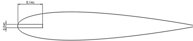
(b) NACA 0015 Erosion
