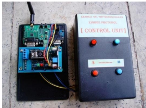
Gambar 8. Unit kendali ON/OFF lampu dengan modul Zigbee
