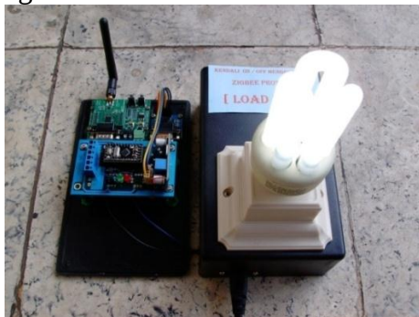
Gambar 9. Unit beban lampu Penerang 18 W dengan modul Zigbee.
