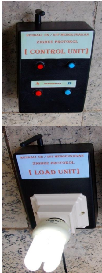
Gambar 10. Pengoperasian Alat Unit Kendali dan Unit Beban
