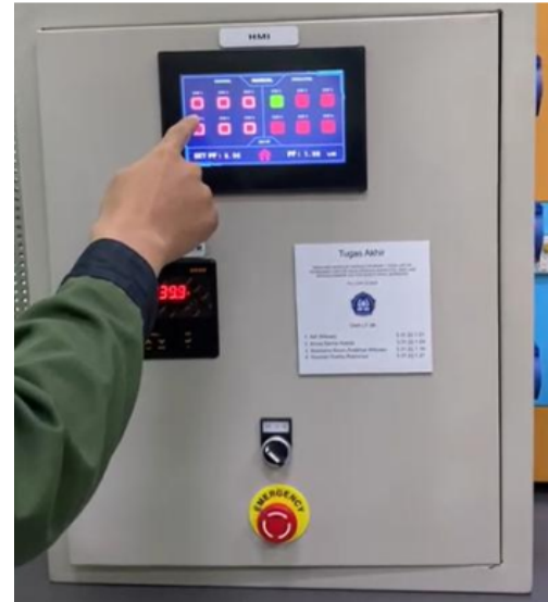
Gambar 2. Tampilan HMI perbaikan faktor daya
