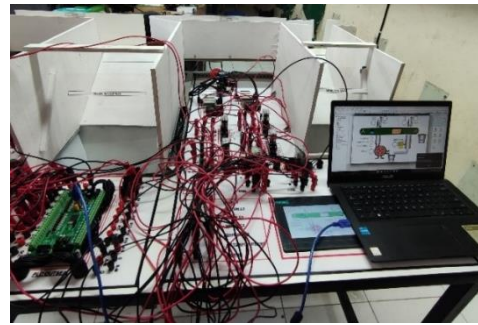
Gambar 5.1. Komunikasi Haiwell Cloud Scada Designer dengan HMI
