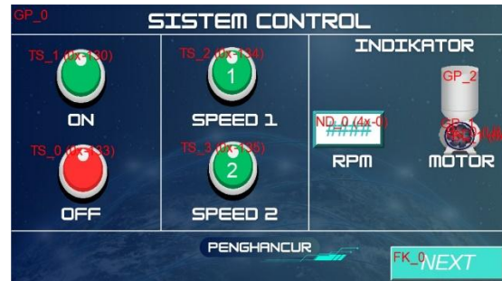
Gambar 3.4 Tampilan alamat menu penghancur pada HMI
