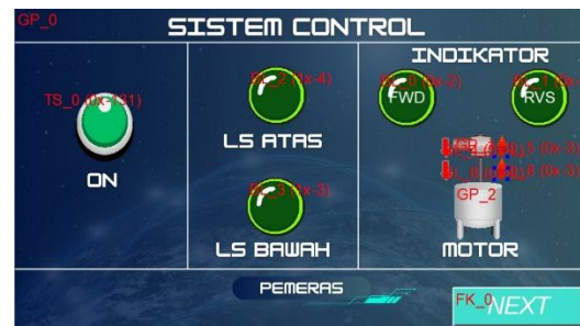
Gambar 3.5 Tampilan menu pemeras pada HMI
