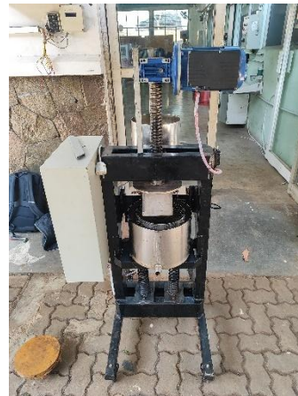
Gambar 4.2 Konstruksi mesin penghancur dan pemeras kunyit.
