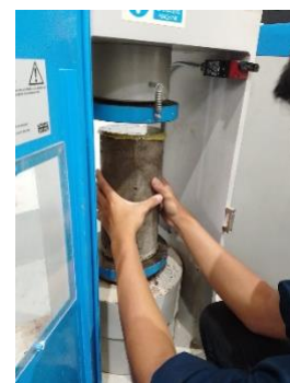
Gambar 3. Proses Tes Tekan Beton
