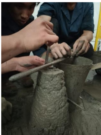
Gambar 2. Pengujian Slump Beton
