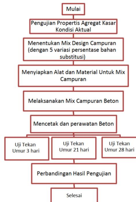
Gambar 2. Diagram alir penelitian dengan 5 variasi persentase bahan substitusi semen menggunakan Abu Kelapa & Sica Fume.
