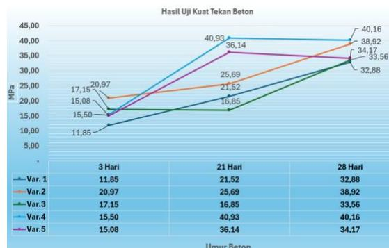
Gambar 5. Kurva hasil nilai kuat tekan beton untuk masing-masing variasi dengan rencana kuat tekan beton 25 MPa. (Sumber: Data primer, 2024)
