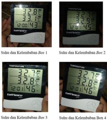
Gambar 13. Pengujian Suhu dan Kelembaban Menggunakan Alat Ukur
