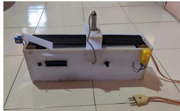
Gambar 5. Prototype alat pendeteksi logam pada Makanan
