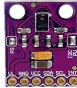
Gambar 3: Sensor Gesture APDS-9960 Sensor Gesture Modul APDS-9960 ini mempunyai enam pin pada modulnya, tetapi dalam penggunaannya yang dipakai hanya lima pin yaitu : pin catu daya positif (VCC), pin catu daya nol (GND), pin serial data (SDA), pin sinkronis clock (SCL) dan pin Interup (INT). Untuk mengkoneksi sensor gesture dengan Arduino yang berfungsi untuk mengolah data, maka pada lubang-lubang pin sensor gesture dipasang dengan pin sisir.
