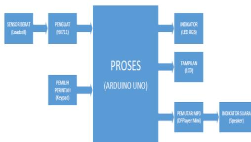
Gambar 9. Diagram Blok
