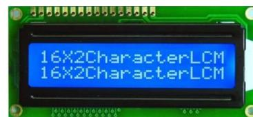
Gambar 3. LCD 16x2
