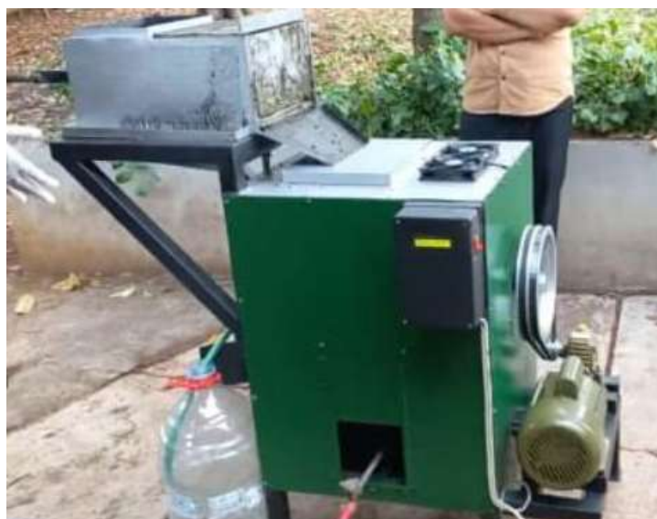
Gambar 3. Hasil rancang bangun mesin pengering slurry
