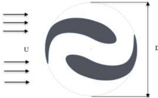
Gambar 1. Turbin Hidrokinetik biomimetik berbasis kontur tubuh ikan haruan ( Channa striata )
