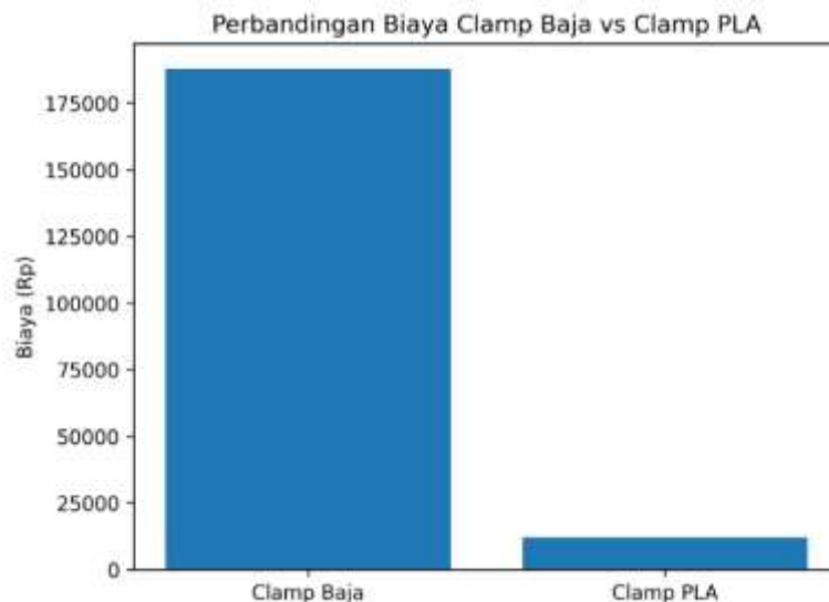
Gambar 6. Grafik Perbandingan Biaya Clamp Baja vs Clamp PLA
