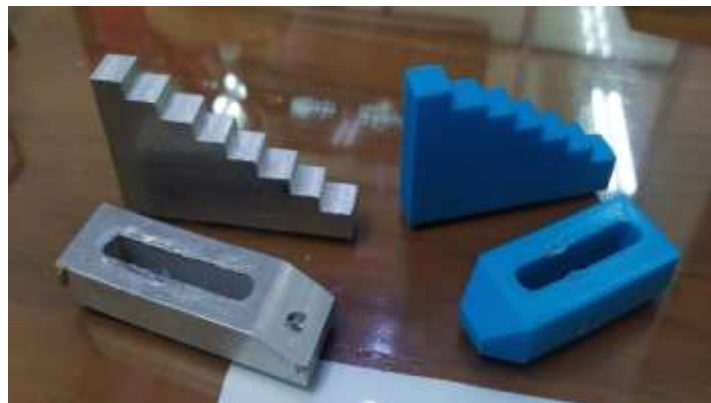
Gambar 2. Clamp Aluminium (kiri) dan Hasil Cetak dengan 3D Printing (kanan)
