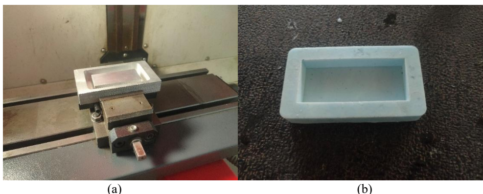
Gambar 1. Cetakan yang sudah dibuat: (a) cetakan aluminium; (b) cetakan silikon
