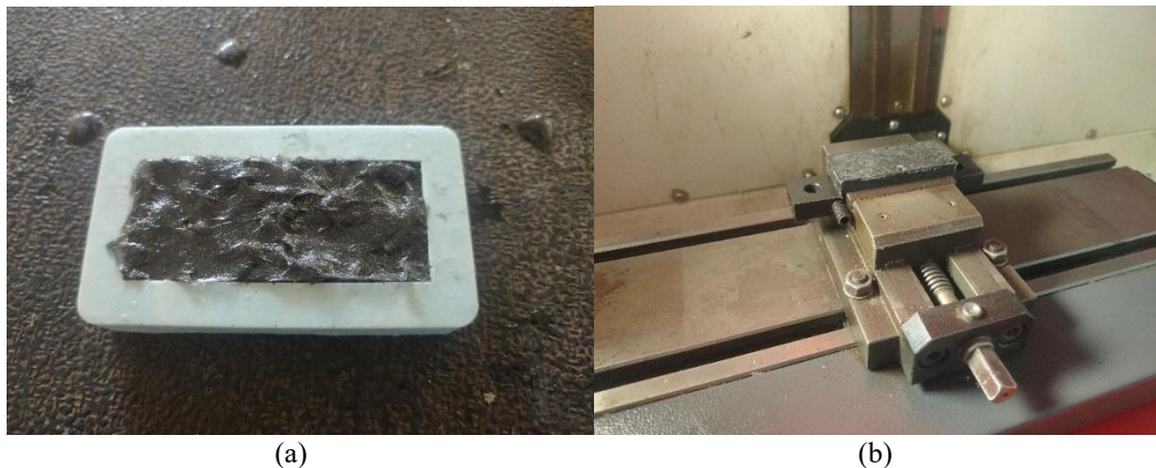
Gambar 2. Spesimen yang sudah dicetak: (a) sebelum melalui proses facing , (b) setelah melalui proses facing
