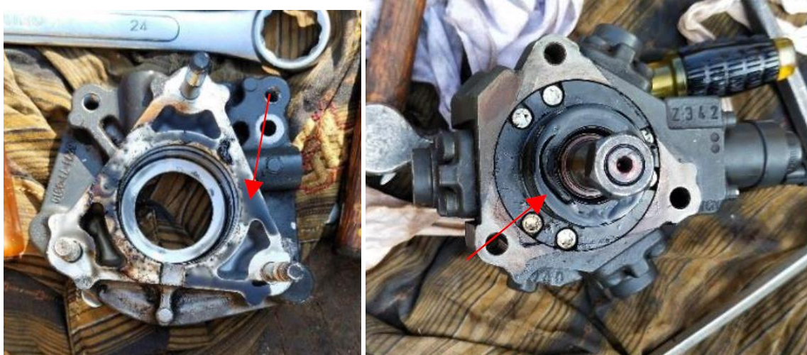
Gambar 5. Sisa fuel pada holder dan supply pump
