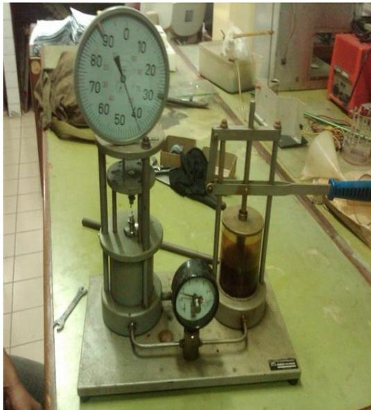
**Gambar 5** Mesin Uji Tarik
