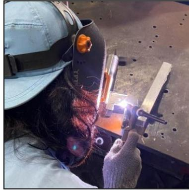
Gambar 1. Pengelasan Produk Inner Joint Tanpa Alat Bantu
