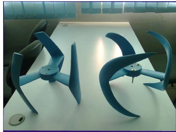
Gambar 5. Turbin zanette (kiri), turbin zanette basis sirip ekor ikan tuna (kanan)
