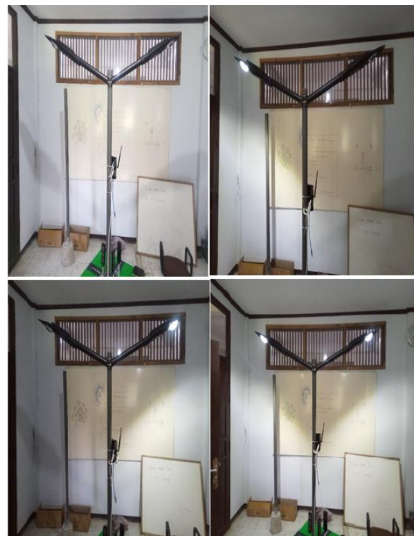
Gambar 12 Aktifasi PJU Menggunakan Smartphone
