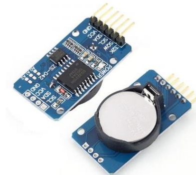
Gambar 3.10 Modul RTC DS3231
