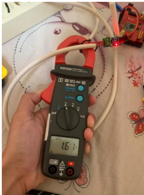
Gambar 4.4 Pembacaan Arus Clamp Meter Pada Setrika 395 Watt
