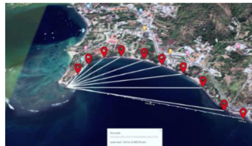
Gambar 12. Pengujian LoRa pada LOS
