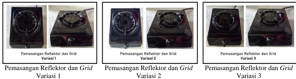
Gambar 7. Pemasangan penambahan material Grid dan Reflektor
